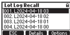
3. Appuyer sur **Détails** pour visualiser les données enregistrées en mode standard. Les valeurs de pH, rédox et température sont affichées.
