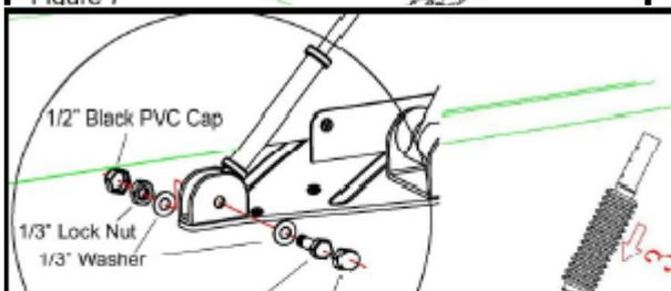
Un côté à la fois, glissez le cylindre jusqu'au stoppeur et installez l'embout du cylindre dans le support en utilisant les boulons 1-1/3" x 1/3" avec les contre-écrous 1/3". Répétez de l'autre côté.
